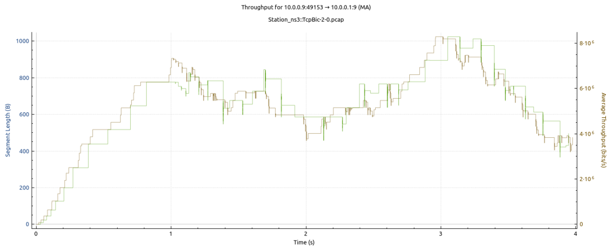
Figura 4.17: Gráfico de Throughput e Goodput do algoritmo Bic gerado a partir do teste com 8 nós
